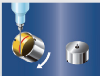
Dosierung von 2-Komponenten- -Epoxidflüssigkeit auf Motoren
